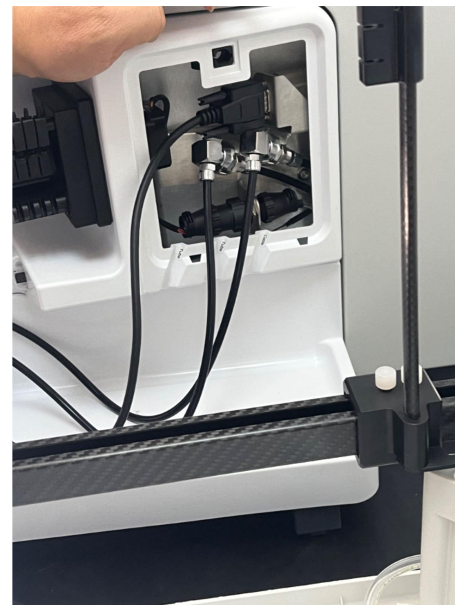
打开盖板将管道和线插好
